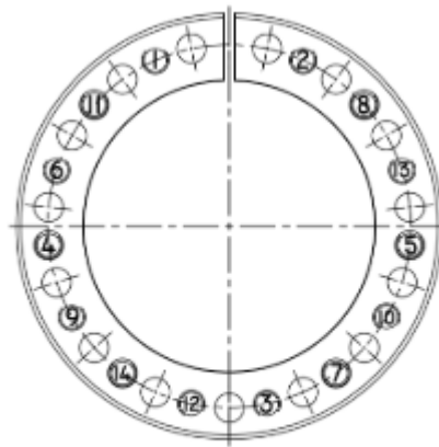
Sequência de aperto na desmontagem
