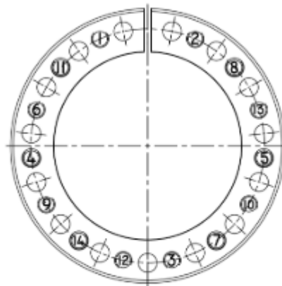
Sequência de aperto na desmontagem
