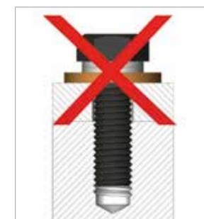
Sem função de bloqueio quando combinado com as arruelas planas e livres
