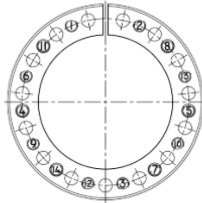
Sequência de aperto na desmontagem
